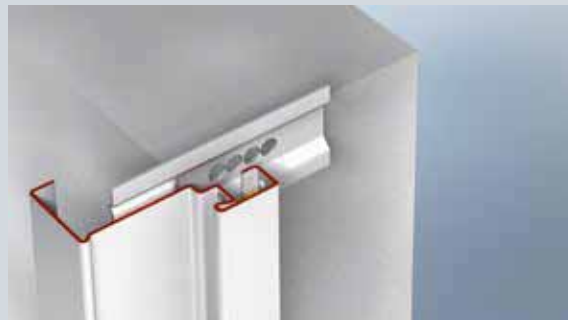
Профиль 1 угловой коробки установить и выровнять в проеме
